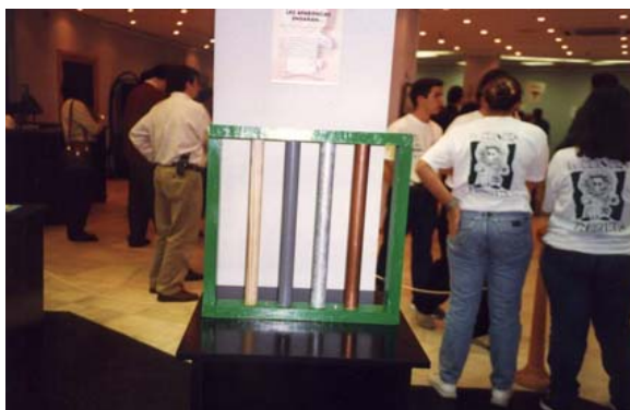
Figura 2.- Módulo para ilustrar las distintas percepciones térmicas al contacto de diferentes materiales.
