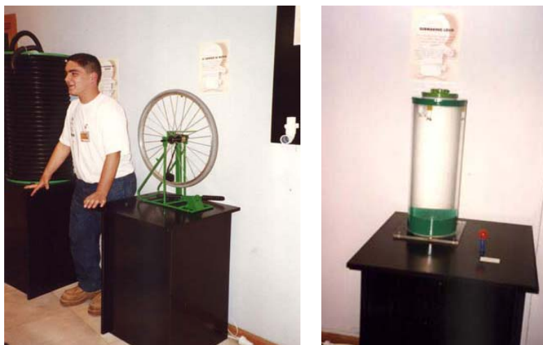
Figura 3.- Módulo para ilustrar el efecto Doppler a partir de chirrido de un timbre solidario a una rueda en movimiento (izquierda). Módulo para ilustrar el ludión o diablillo de Descartes (derecha). El pulsador rojo permite comprimir el agua del recipiente haciendo descender la pequeña cápsula interior.
