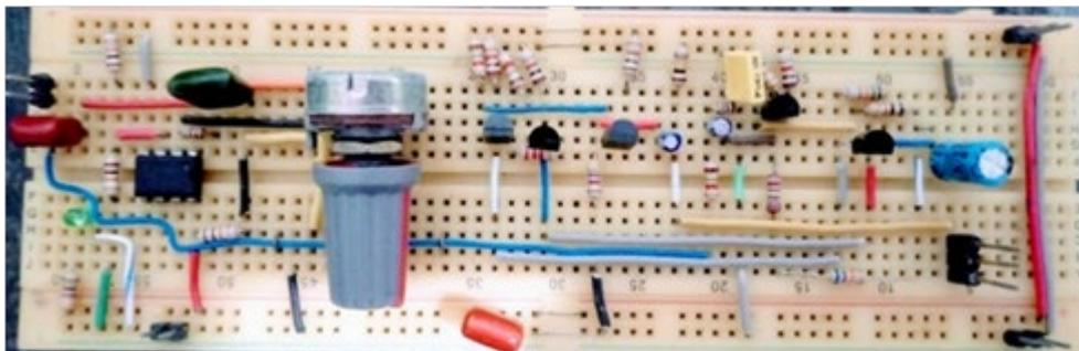
Figura 5 – Circuito amplificador para microfone com atenuação de ruído, montado na placa de ensaio.
