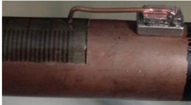
Figura 4 – Montagem do microfone de eletreto interno e externo.
