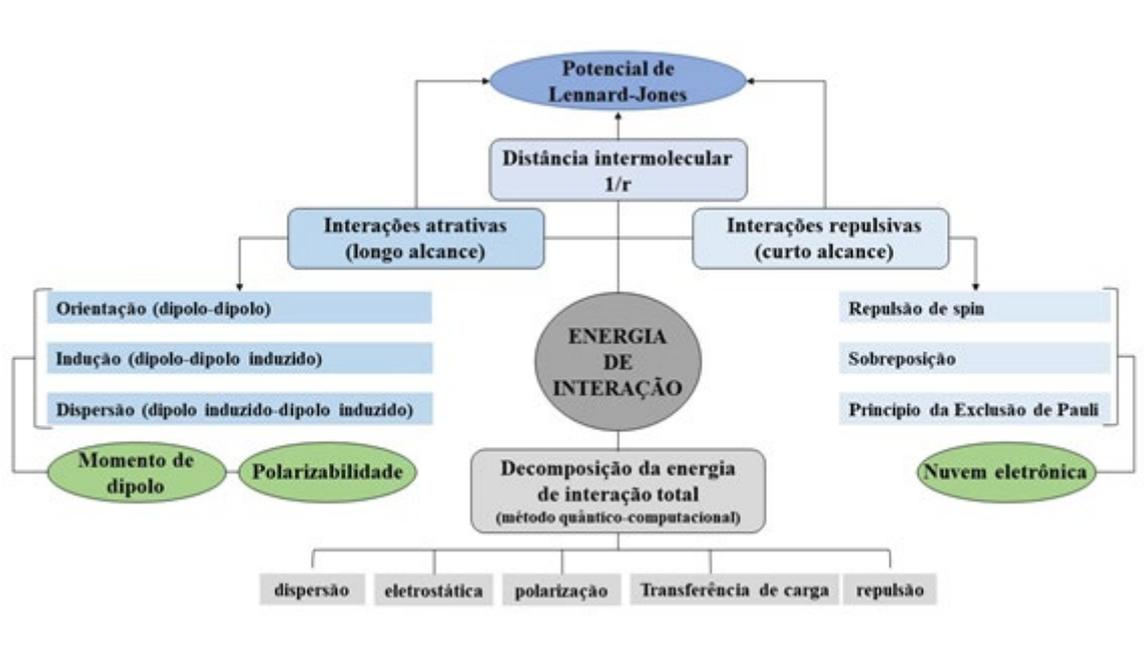
Figura 3. Conceitos fundamentais sobre energia de interação com base na revisão bibliográfica.
