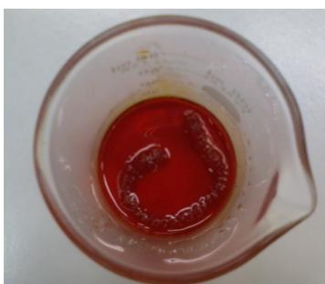
Figura 9.- Fio de lã sendo tingido pelo corante azóico.
