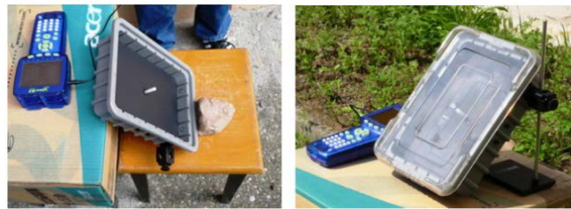
Figura 8.- Monitoramento da temperatura de uma caixa com o fundo preto na presença e ausência de uma tampa de plástico (Besson et al. 2010).
