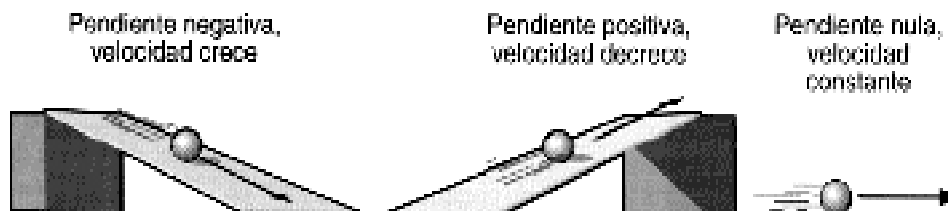
Figura 12.- La imagen presenta como evidencia experimental el argumento de Galileo.
